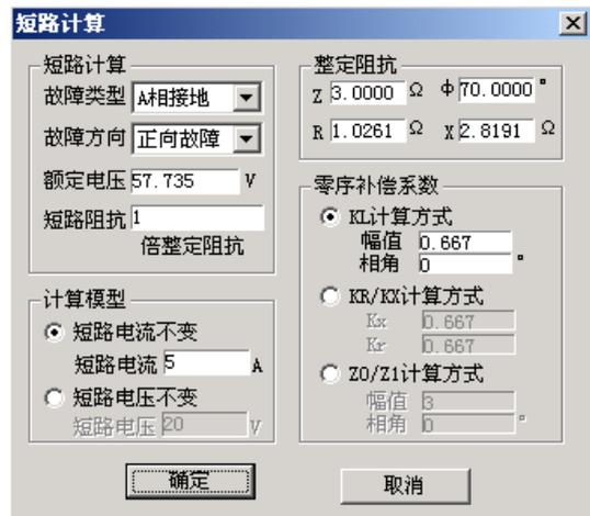
“短路阻抗”和该“短路电压”计算出相应故障类型下的“短路电流”。做“距离保护”试验时，有时可通过灵活设置短路电流，在不退出零序保护的情况下躲开零序保护的抢动。
