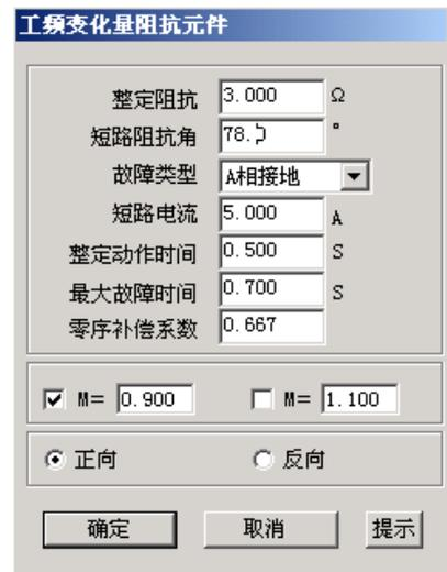
M 的值默认情况下有 0.9 和 1.1 两种设置，一般地，M=0.9 时，保护应可靠不动作，M=1.1 时，保护应可靠动作。设置 M=1.2 时，可以测出保护的的动作时间。点击界面中“提示”按钮可以获得更多提示。
