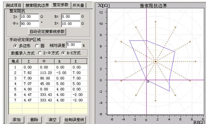
参数时，R 和 X 都可以设置为负数。各角点添加完后点击“画图”按钮，至此软件即绘出了理论的阻抗边界曲线以及相应的误差曲线（以虚线表示）。此时可用鼠标移至图形的中心位置点击鼠标左键，以设置扫描中心点，如右图所示。
