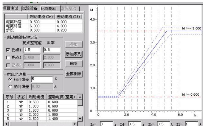
或“添加”将搜索线数据填入测试数据列表中。选“开始试验”即可进行测试。选“删除”或“全部输出”可以删除所选择的单条或全部搜索线。
