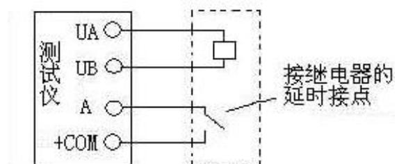
选择“手动”试验方式。开始输出一定时间后，就能测试出其动作时间。
