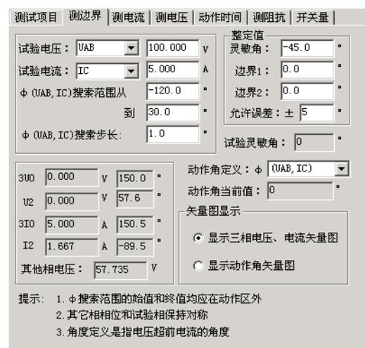
设置  $\Phi(U, I)$  的搜索范围时，首先应了解保护装置的“最大灵敏角”的整定值，要保证设置的搜索范围能覆盖保护实际的两个动作边界，即搜索始值和搜索终值均应设置在动作区之外，测试仪从“非动作区”向“动作区”搜索。
