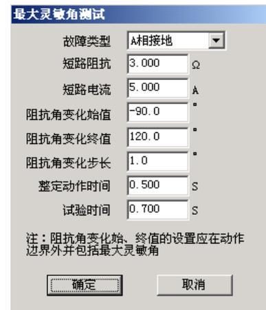
整定值，为节约时间，在第一次测试时将变化步长设置得大一些，可以测试出大概的边界。然后将阻抗角变化始值、终值设置在已知的两边界附近，并且给定一个合适的变化步长就可以测出精度符合要求的最大灵敏角。
