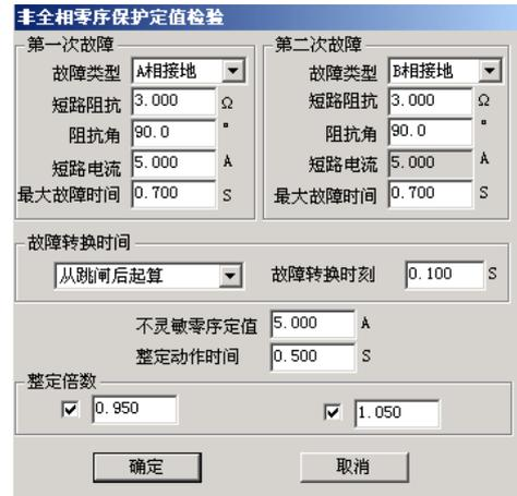
第二次故障的出现时刻可以设定。可选择从第一次跳闸后起算何时出现，也可设定从第一次故障开始时起算何时出现。设定时刻到将自动输出第二次故障。若保护的重合闸功能未退出，则该时刻应设置为重合闸时间未到。
