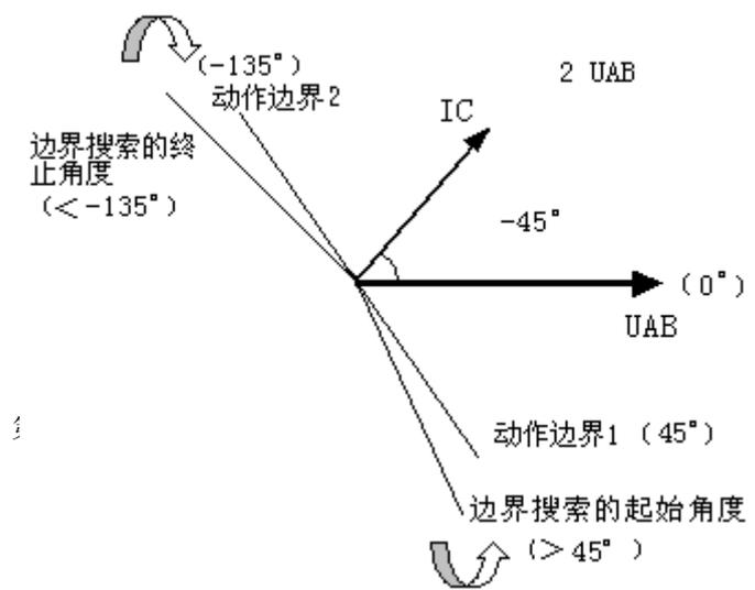
$\Phi(U, I)$  为  $20^\circ$  时保护不动作，在  $0^\circ$  时动作，则说明保护的一条动作边界在  $0^\circ \sim 20^\circ$  之间。用同样的方法找出保护动作的另一条边界的大致范围，假设为  $-130^\circ \sim -120^\circ$ 。
