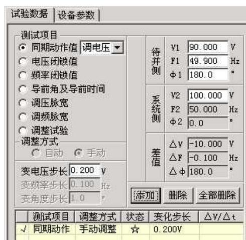
项。选中其中一项后，再设置界面下端的“变电压（频率、角度）步长”。开始试验后，可按所设置的变化步长手动增减相应的量至同期接点动作，即测出相应的同期动作值。用该功能也可对线路检同期或检无压的重合闸保护进行测试。
