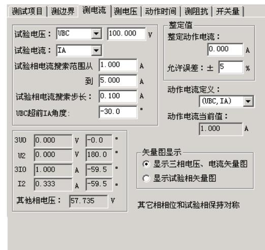
角。一般，当角度为最大灵敏角或接近最大灵敏角时，保护动作最灵敏，测出的动作电压也趋于一个定值。当设置的角度接近两个动作边界或稍微超出边界，测出的动作电压可能偏大或不动作。
